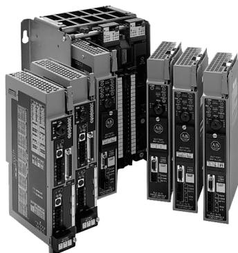
Tous les automates PLC-5 comportent des ports intégrés configurables en Data Highway Plus (DH+) ou RIO universel. Outre la communication d'égal à égal entre le PLC-5, d'autres automates et équipements, une connexion DH+ prend en charge la programmation et l'accès aux informations à distance. Une connexion RIO universelle permet l'échange de données en temps réel pour les E/S, l'interface opérateur et d'autres équipements de fabricants tiers.
