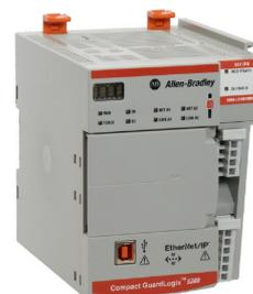
**IMPORTANT** Vous devez utiliser des alimentations secteur SELV (très basse tension de sécurité) / PELV (très basse tension de protection) pour les alimentations MOD (module) et capteur actionneur SA (capteur actionneur). Vous pouvez uniquement utiliser l'alimentation SA c.c. avec des automates Compact GuardLogix 5380.
